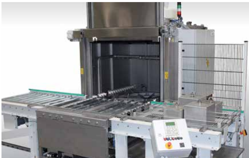
Вариант: OceanRW с рольгангом, пневматическим загрузочным устройством и адаптированной сопловой рамкой
