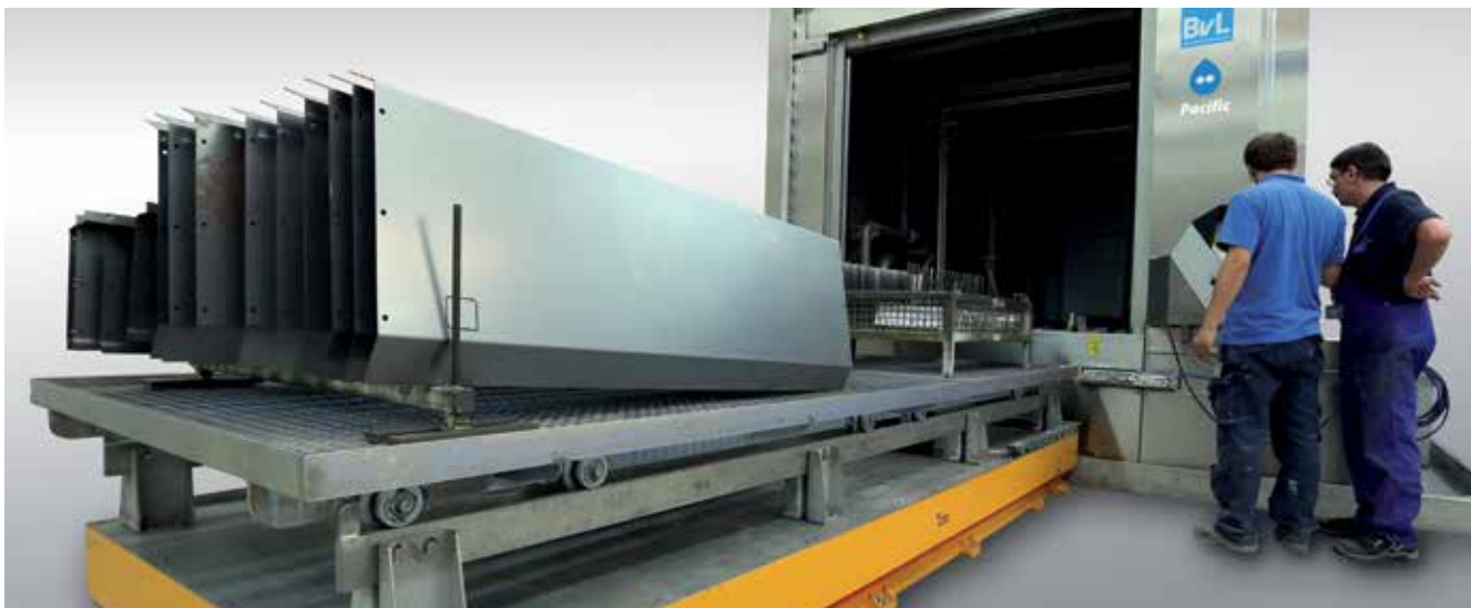
Вариант Расифста со столом параллелограммной конструкции и автоматическим задвигающимся и выдвигающимся элементом
