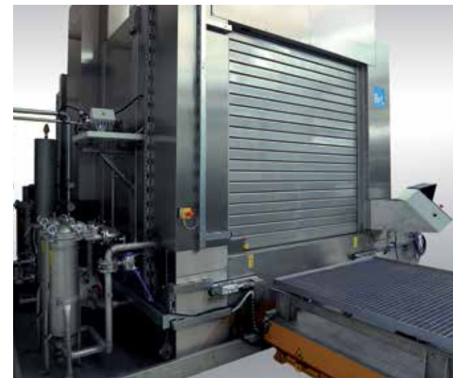
Вариант Расифста с шторными воротами, фильтром и теплообменником
